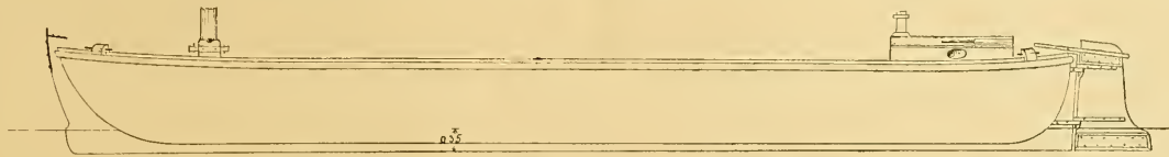
SUIJKPRAAM. BAGGERPRAAM. (GRONINGEN) DREDGING BARGE. CHALAND DE DRAGAGE.
